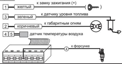
Дополнительные возможности МК при подключении **опциональных** цепей:
